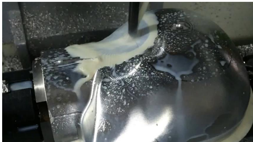
Obróbka odlewu ze stopu AZ91
