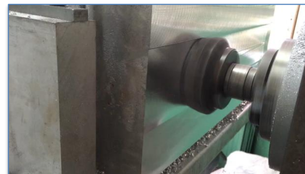
Skórowanie bloku magnezowego
